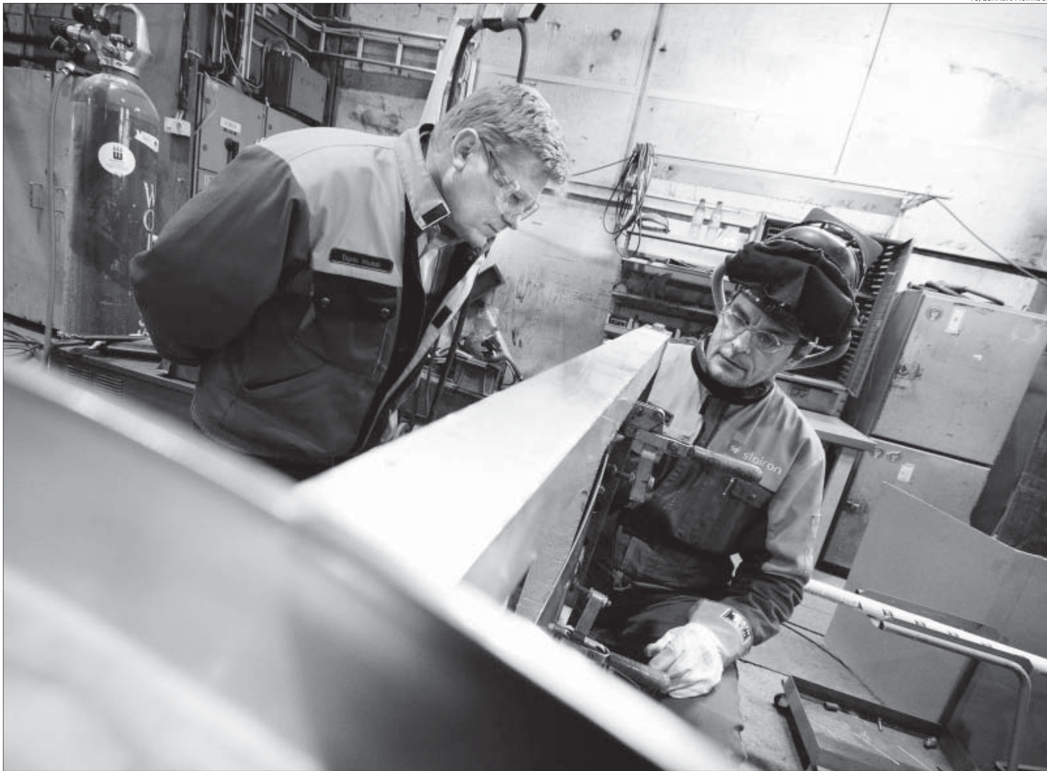
Staironin vahvaa osaamista ovat paperikoneiden ilmajärjestelmälaitteet. Tapio Hussi seuraa (vas.), kun Tommi Lehtinen plasmahitsaa lämmönvaihinta.
